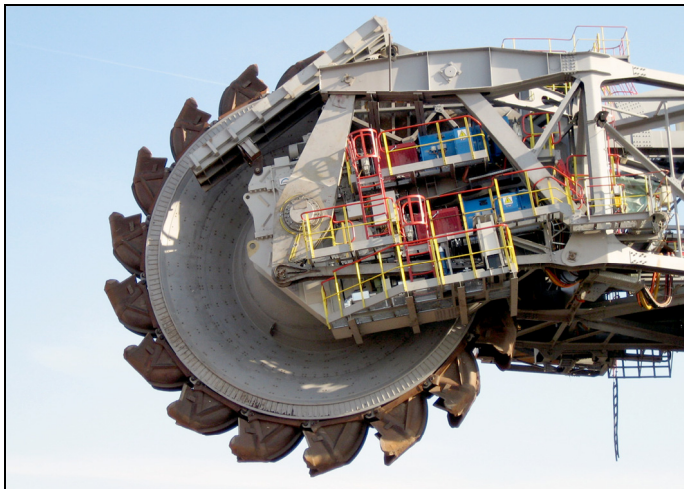
Rys. 1. Zespół urabiający (koło czerpakowe) SRs 2000 stare — nowe
