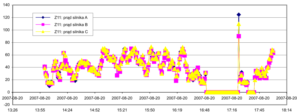
Rys. 3. Przykładowe profile prądowe dla układu napędowego przemożnika
