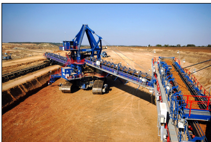
Rys. 3. Przenośnik samojezdny współpracujący z koparką kompaktową PE100-1600/1,5 × 20 pracująca w kopalni węgla brunatnego na Węgrzech. Producent SANDVIK (fot. Kasztelewicz 2009)
