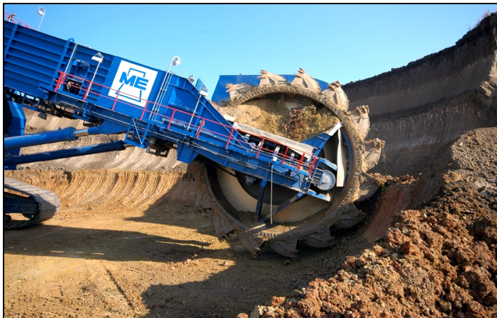
Rys. 1. Koparka kompaktowa PE100-1600/1,5 × 20 pracująca w kopalni węgla brunatnego na Węgrzech. Producent SANDVIK (fot. Kasztelewicz 2009)
