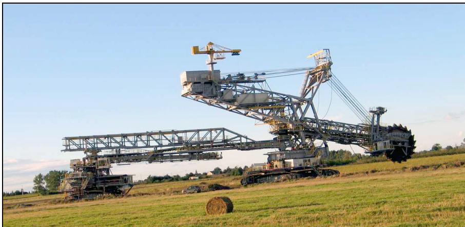
Rys. 1. Widok koparki SRs-1800 podczas transportu
