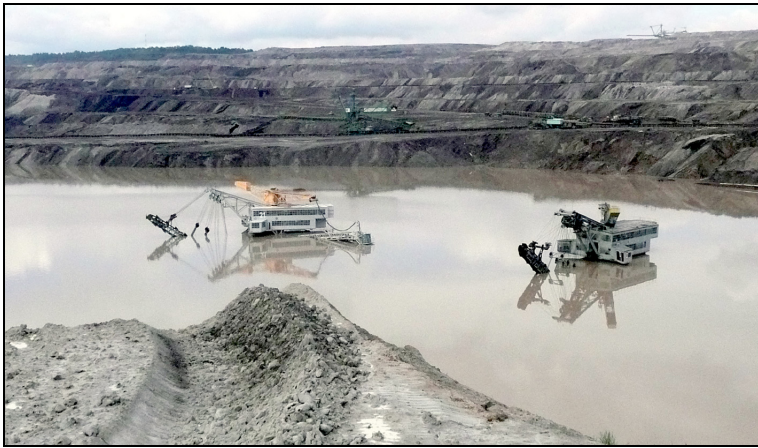
Rys. 7. Podtopione koparki łańcuchowe RS-560 (K-21 i K-30)
