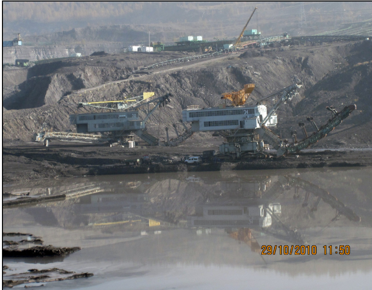
Rys. 8. Odzyskane koparki łańcuchowe RS-560 (K-21 i K-30)
