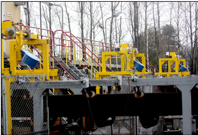
Rys. 2. Nowy ciągły system monitoringu jakości węgla w KWB „Bełchatów”
