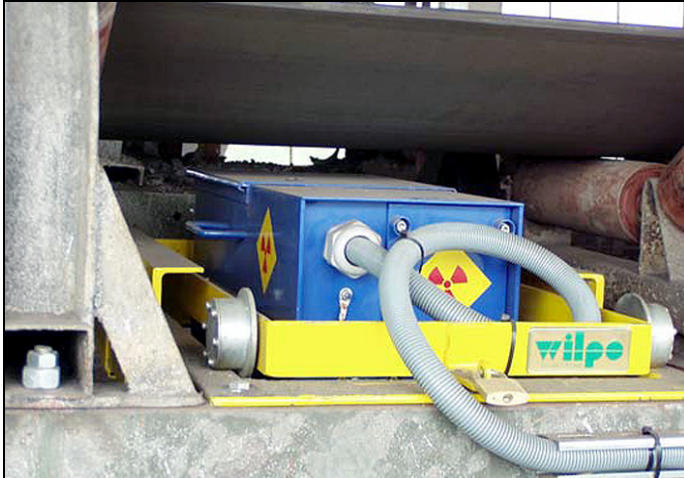
Rys. 1. Głowica pomiarowa popiołomierza podtaśmowego WILPO C 212
