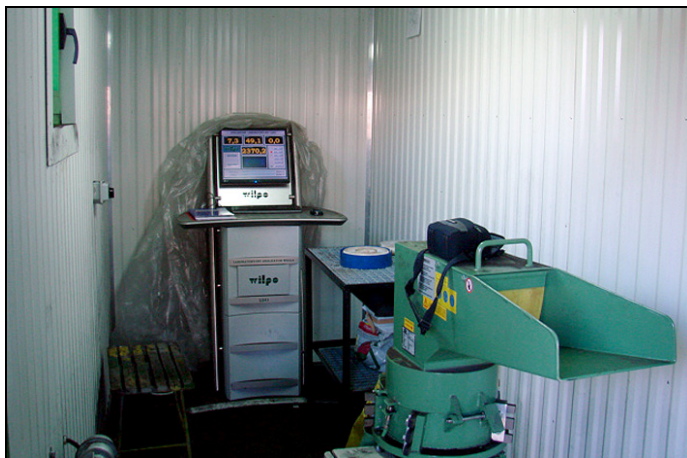
Rys. 3. Widok analizatora WILPO L 241 zainstalowanego w przystosowanym pomieszczeniu na kopalce
