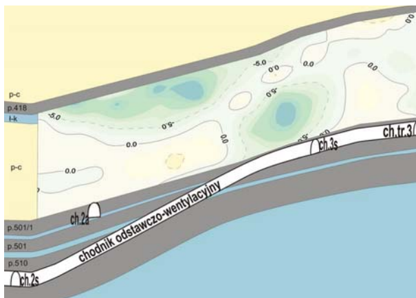
Rys. 8. Względne zmiany prędkości fali podłużnej pomiędzy pokładami 418 i 501/1 w okresie między czwartą (wrzesień 2009) a piątą serią pomiarową (maj 2010)
