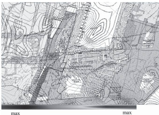
Rys. 5. Szkic izolinii prędkości fali P wyznaczonych metodą tomografii pasywnej na podstawie danych z okresu od 01.07.2009 do 31.07.2009 z pola eksploatacyjnego G-7/5 O/ZG Rudna
