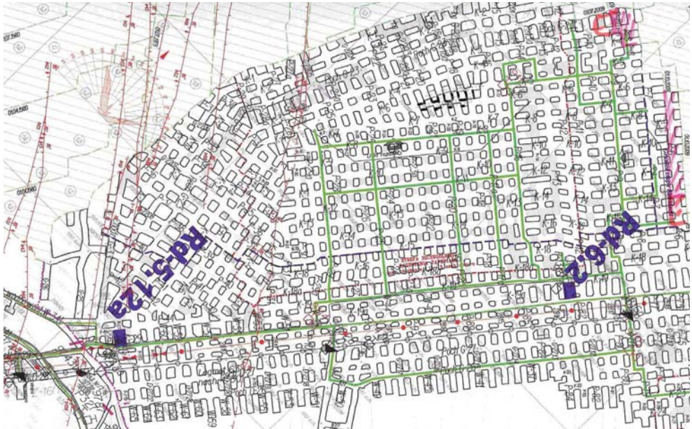
Rys. 4. Szkic wzrostki eksploatacyjnych w polu G po zakończeniu rozcinki resztki (widoczne wzrostki wypełnione skałą i drogi transportowe wewnątrz pola eksploatacyjnego)
