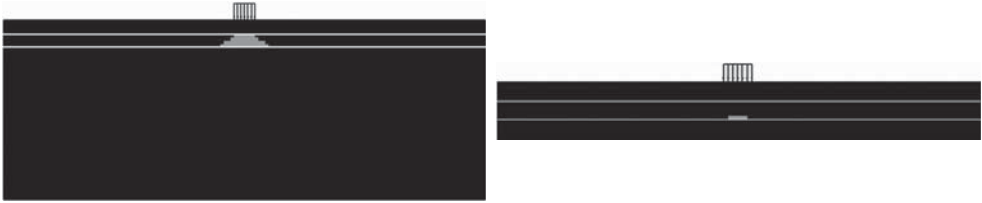
Rys. 5. Strefy plastyczności w warstwie podbudowy ( c = 70 \text{ kPa} , \phi = 30^\circ ) dla modeli j.w.
