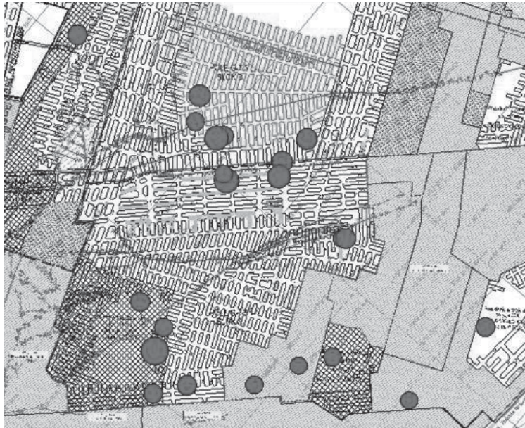
Rys. 3. Lokalizacja źródeł wstrząsów o energiach E \geq 1,0 \cdot 10^5 J w polu G-7/5 w okresie od 01.10.2009 do 30.09.2010 roku [4]
