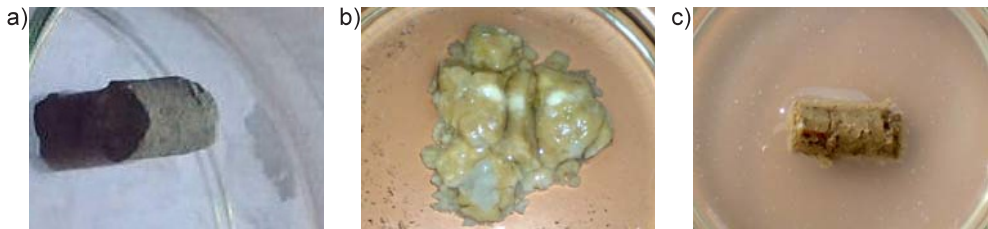
Rys. 13. Wyniki badania pęcznienia beleczek iłowych pod wpływem wody i badanej płuczki: a) beleczka wyjściowa, b) pęcznienie w wodzie, c) pęcznienie w płuczce
