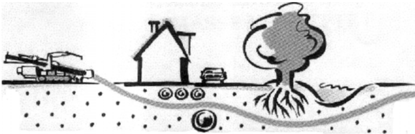
Rys. 1. Ilustracja przedstawiająca ideę horyzontalnych przewiertów sterowanych [7]
