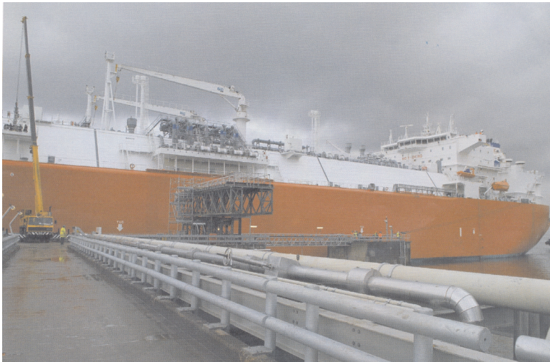
Rys. 2. Pierwsze regularne dostawy regazyfikowanego na pokładzie metanowca LNG, w ilości 5 mld m 3 /rok gazu ziemnego, do gazociągu lądowego w porcie Teesside w pñ.-wsch. Anglii, metodą „alongside moored ship” [5, 6]
