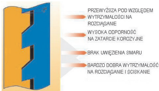
Rys. 5. Zarys gwintu hakowego [7]
