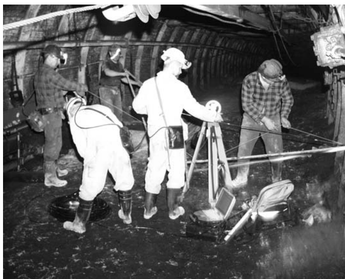
Fot. 2. Wyprowadzanie sondy georadarowej z otworu badawczego
