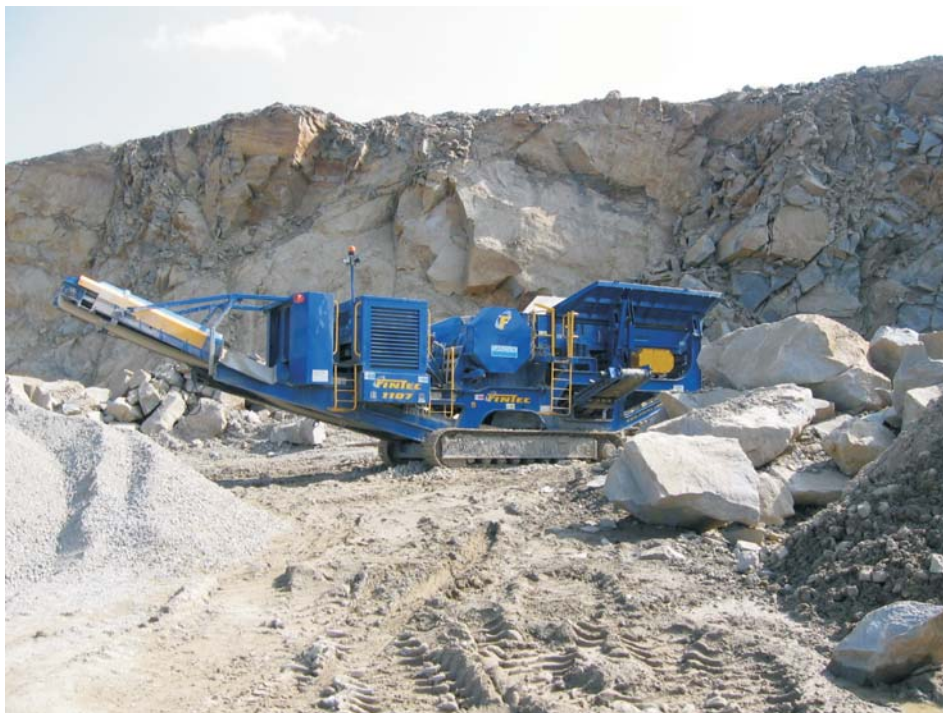
Rys. 5. Mobilna kruszarka szczękowa w kopalni piaskowca „Barwałd” (fot. M. Baradziej)
