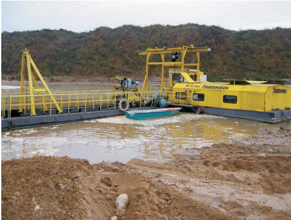
Rys. 6. Pogłębiarka ssąca (refuler) w kopalni kruszywa naturalnego „Żabi Róg” (fot. M. Baradziej)
