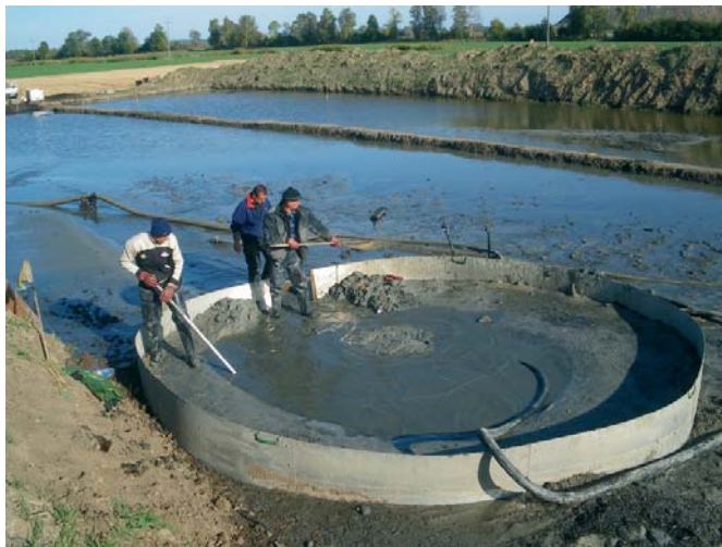
Fig. 5. Podziemne ługowanie wodą aluwów na Żuławach Wiślanych celem pozyskiwania bursztynu
