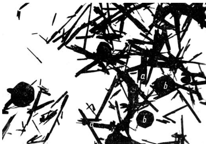
Fig. 9. Obraz elektrony krysztalów szajbelytu (a) i boracytu (b). Powiększenie 9000× (Fijał 1973)
