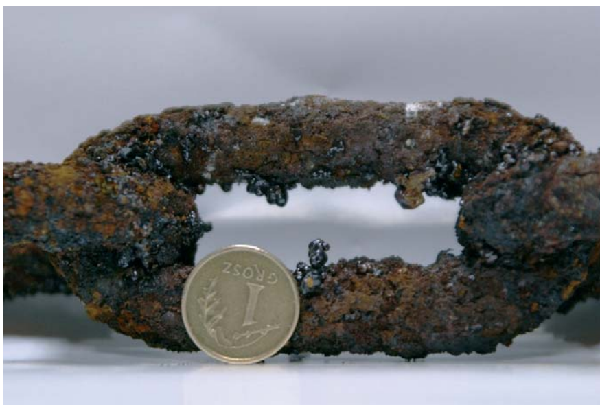
Fig. 7. Pęcherze na fragmencie metalowego łańcucha
