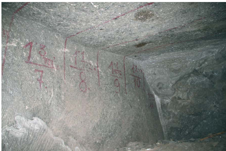
Fig. 13. Widok fragmentu komory przy podłużni Franciszek 1 z widoczną odbiórką robót (fot. W. Wiewiórka)
