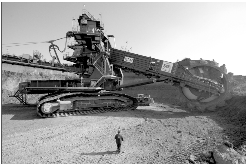
Rys. 1. Koparka kompaktowa PE100-1600/1,5 × 20 pracująca w kopalni węgla brunatnego na Węgrzech. Producent SANDVIK [fot. Kasztelewicz 2009]
