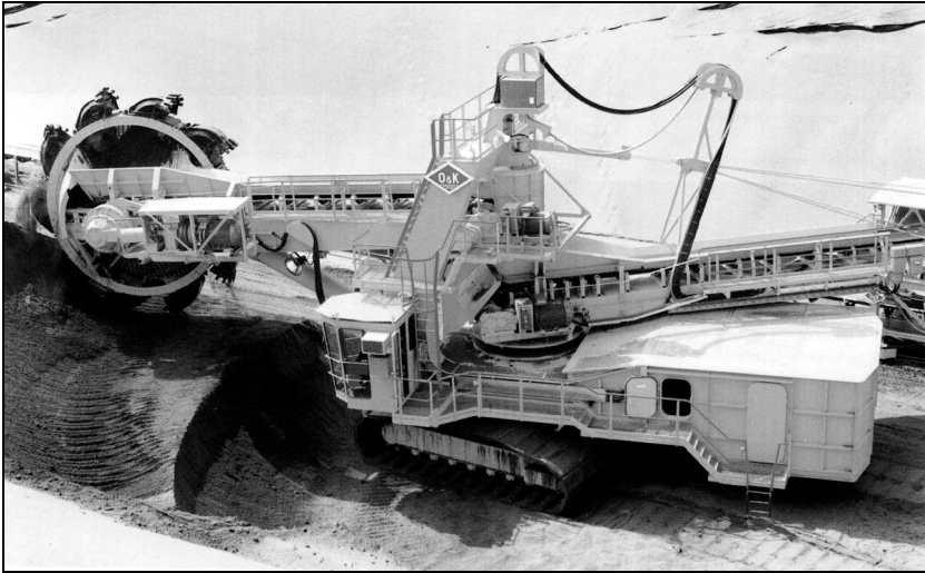
Rys. 3. Koparka kompaktowa S400 pracująca w kopalni rudy żelaza w Nowej Zelandii. Producent: O&K (obecnie Krupp) [fot. Trümper 1996]
