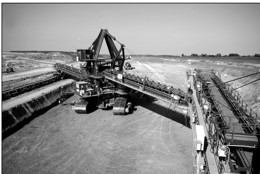
Rys. 2. Samojezdny przenośnik odbierający PB-100 współpracujący z koparką kompaktową PE100-1600/1,5 × 20 pracująca w kopalni węgla brunatnego na Węgrzech. Producent SANDVIK [fot. Kasztelewicz 2009]
