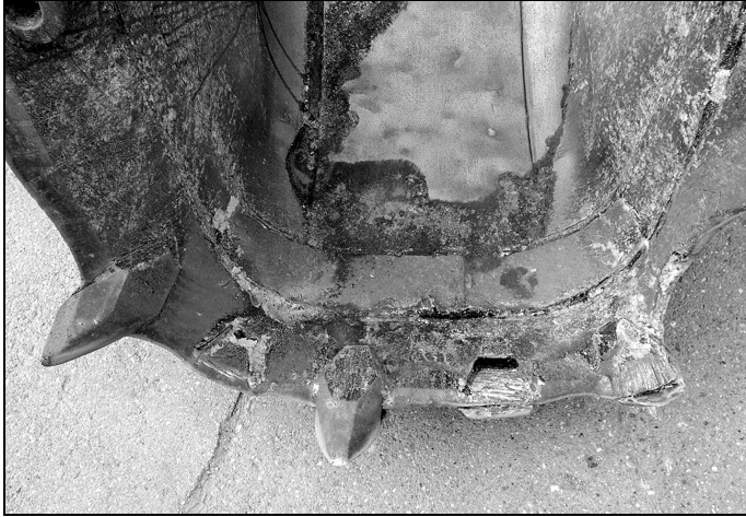
Rys. 8. Zużyte zęby kute i uszkodzony nóż czerpaka
