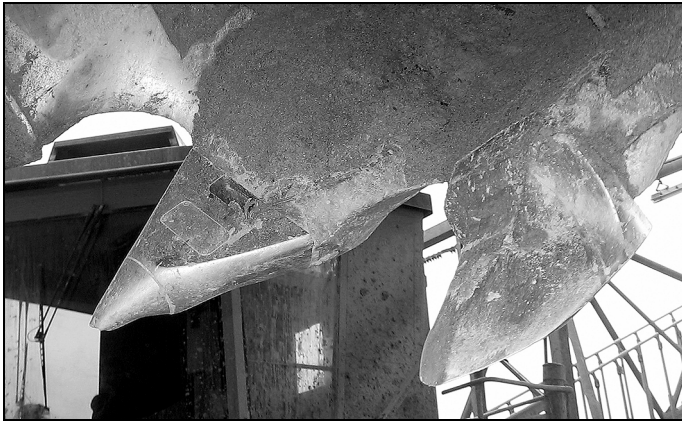
Rys. 15. Zużycie zębów ACX i WKL-3 po 29 godzinach pracy [11]
