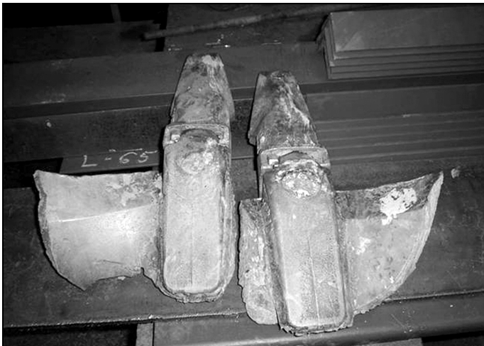
Rys. 11. Uszkodzenie noża z zębami firmy ESCO [12]
