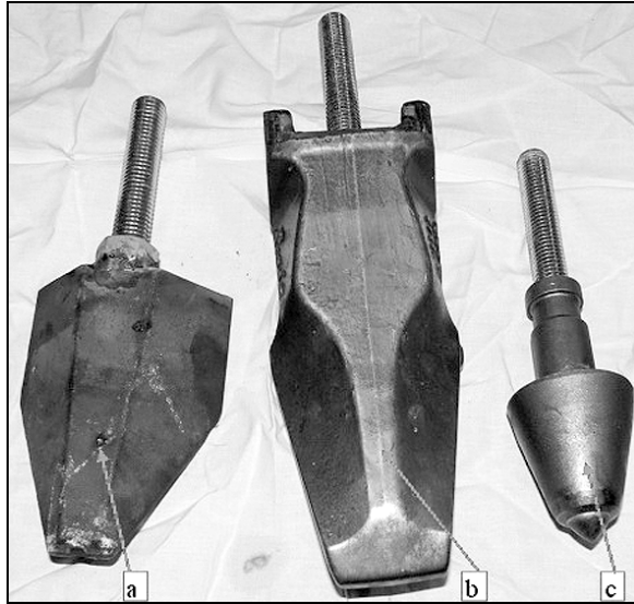
Rys. 11. Ząb kuty o kształcie ostrosłupowym (a); ząb firmy Esco (b); głowica skrawające zęba CX-25/38 (c)
