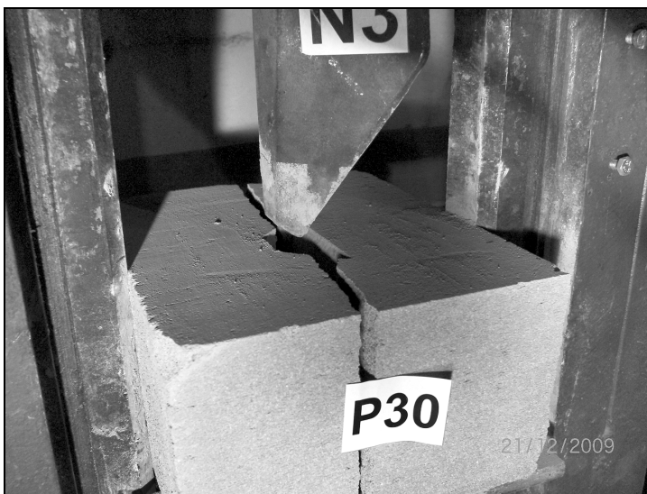
Rys. 18. Spękanie minerału w czasie niszczenia go zębem kutym ostrosłupowym
