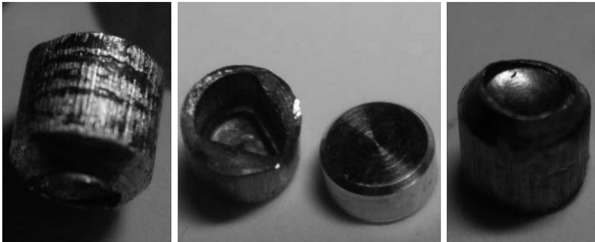
Rysunek 10. Z lewej: komponent formowany w temp. 20°C z pęknięciami na brzegach. Z prawej: materiał i komponent formowany w temp. 400°C [8]
