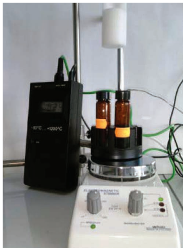
Rysunek 2. Naczynka z próbkami na statywie z mieszadłem magnetycznym (fotografia wykonana przez autora pracy)
