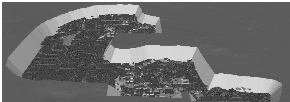
Rys. 1. Wizualizacja jakościowego modelu blokowego (tylko komórki złożowe) na tle modelu sieciowego wyrobiska docelowego W1 (widok z kierunku zachodniego); kolory komórek zgodne z klasyfikacją złoża według wartości opałowej (por. tab. 1b); źródło: Datamine Studio
