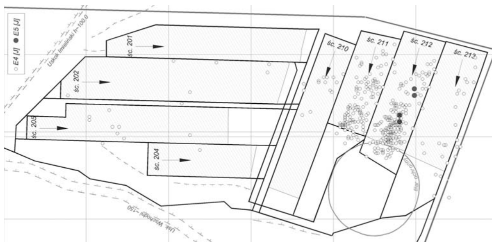
Rys. 2. Wstrząsy zarejestrowane przez Stację Geofizyki KWK „Ziemowit” w trakcie eksploatacji pokładu 206 w bloku E
