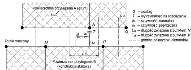
Rys. 3. Element typu interface reprezentowany przez dwie powierzchnie przylegania A (grunt) i B (konstrukcja stalowa)
