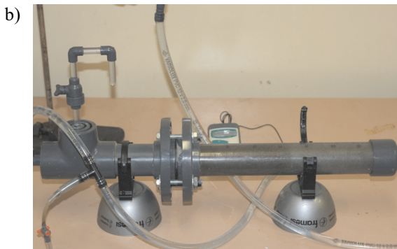
Rys. 1. Przyrząd Kaczyńskiego do oznaczania współczynnika filtracji gruntów spoistych [4, 6]: a) schemat przyrządu; b) widok przyrządu na stanowisku badawczym
