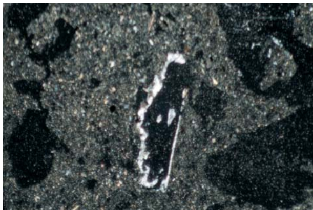
Fig. 8. Sedymenacyjny zuber z olistostromy wielickiej. Widoczne ciemne, zdeformowane ziarna halitu (w środku halit z obwódką gipsową). Mikroskop polaryzacyjny, polaroidy X, powiększenie 10×
