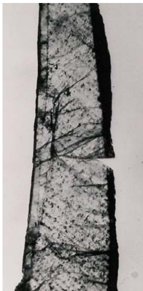
Fig. 4. Kryształ gipsu (gipsy wielkokrystaliczne, złożę Basznia), który krystalizował na dnie zbiornika. Materiał detrytyczny, który opadł z wody na kryształ gipsu, lokuje się na górnych powierzchniach wzrostu kryształu (w kryształe widoczne delikatne smugi). Skala 2:1
