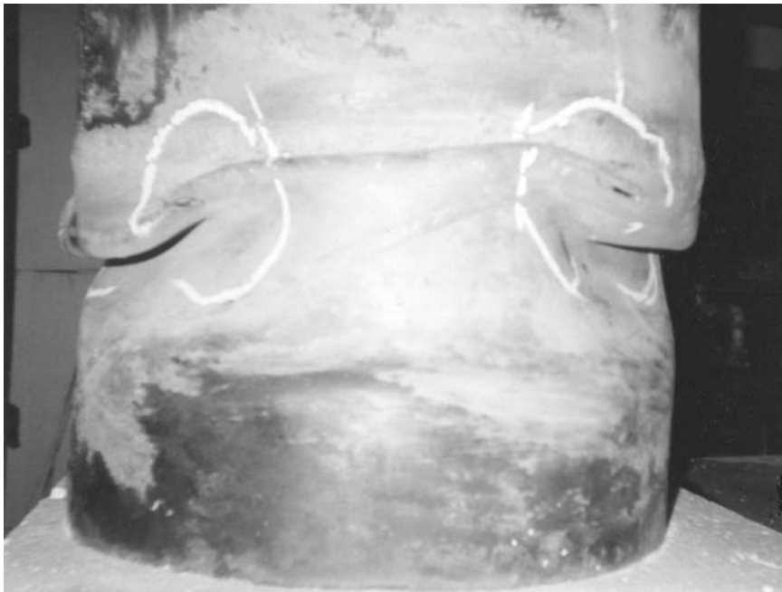
Rys. 12. Fragment pofalowanej rury
