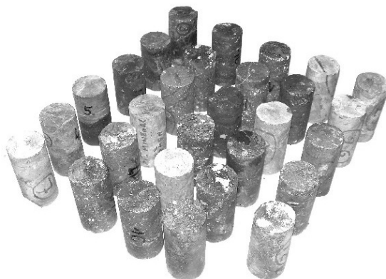
Rys. 3. Próbkki złoża mineralnego przygotowane do badań (29 próbek o średnicy 42 mm)
