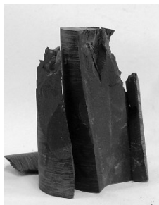
Rys. 8. Zniszczona próbka nr: wapień 25-1
