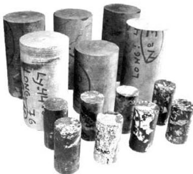
Rys. 2. Próbkki wapienia (6 próbek o średnicy 63 mm) i próbkki złoża mineralnego (8 próbek o średnicy 30 mm) przygotowane do badań
