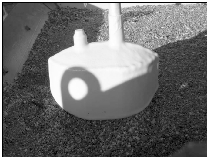
Rys. 6. Pływak zastosowany w osadzarce do pozyskiwania żwiru i piasku
