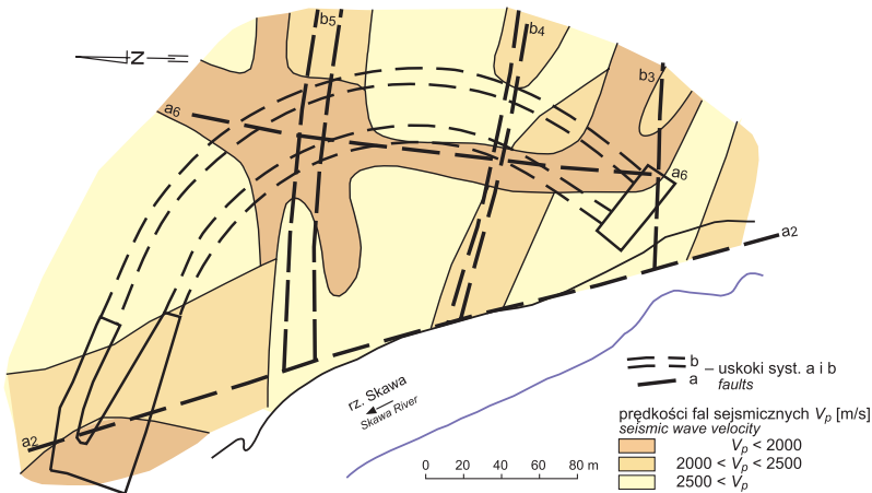
Fig. 3. Mapa prędkości fal sejsmicznych V_p w stropie masywu w rejonie lokalizacji sztolni
