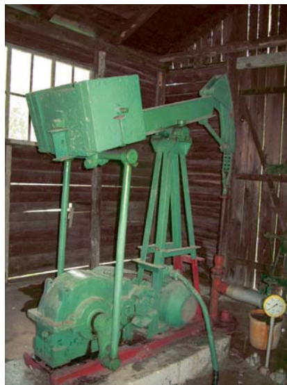
Fig. 1. Eksploatacja wód leczniczych z ujęcia Helena pompą żerdziową typu „Konik”
