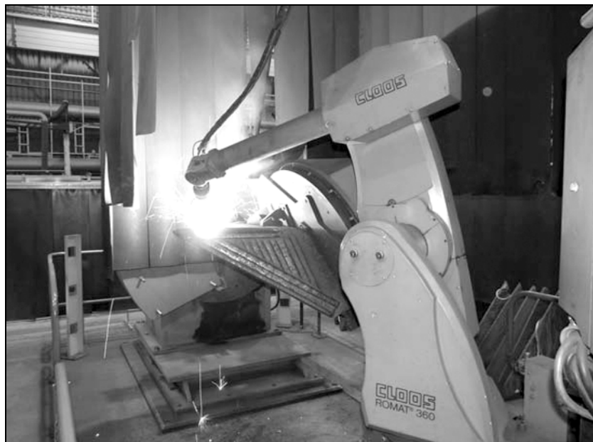
Rys. 3. Stanowisko zrobotyzowane ROMAT 360 do napawania naroży
