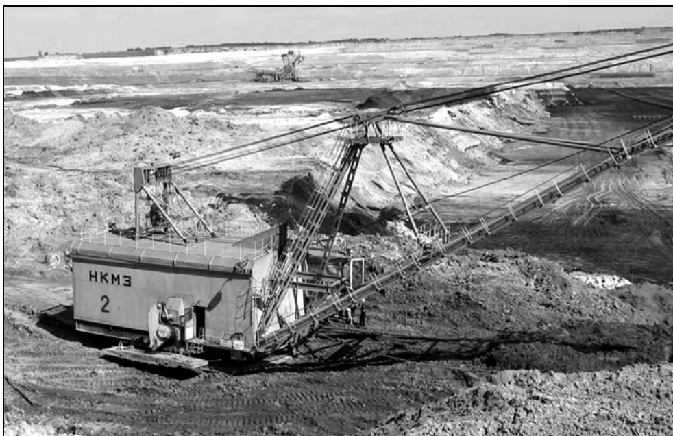
Rys. 1. Widok koparki Esz-6.3/45 nr 2 w miejscu jej pracy
