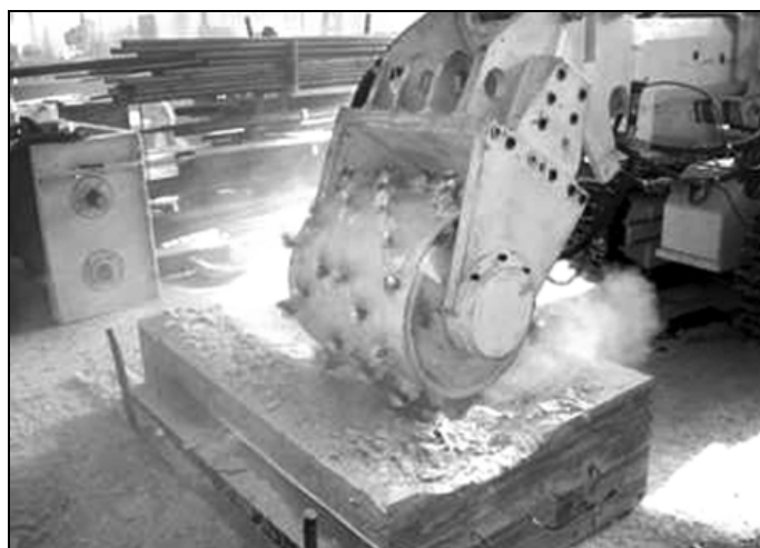
Rys. 7. Widok ładowarki z organem frezującym podczas prób urabiania bloku betonowego [2, 3]
