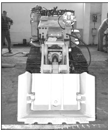
Rys. 4. Widok prototypowej ładowarki z zamontowanym zespołem ładującym wykonanym jako czerpak z wysuwną tylną ścianką [2]
