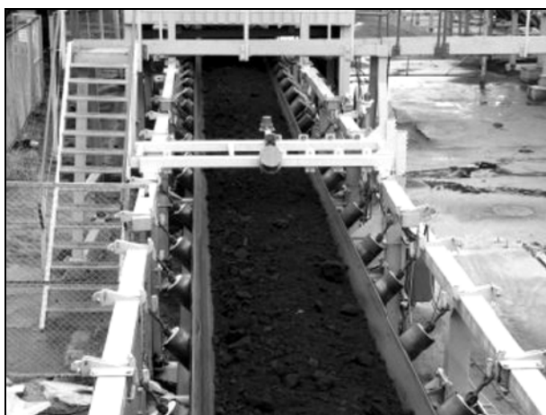
Rys. 1. Prototyp popiołomierza na taśmie 15.11 (widok z góry)
