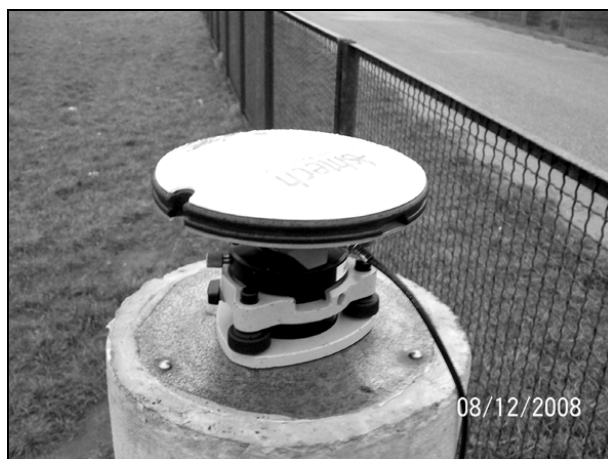
Rys. 3. Realizacja pomiaru GPS na punkcie referencyjnym
