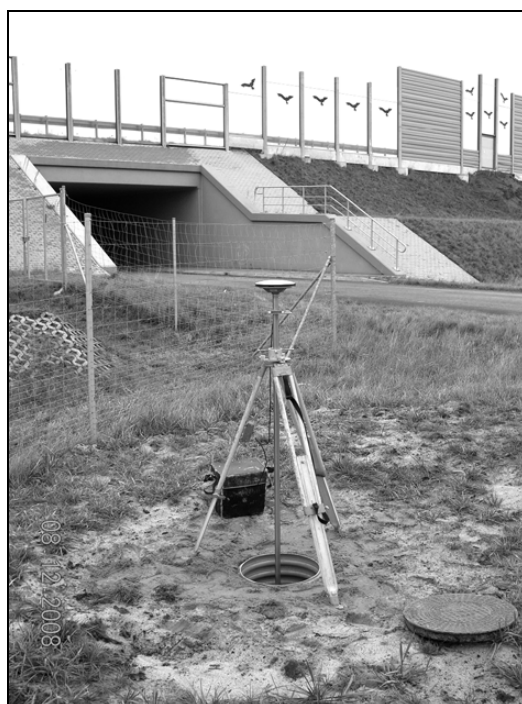
Rys. 4. Realizacja pomiaru GPS na punkcie kontrolowanym
