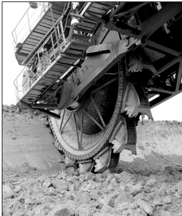
Rys. 2. Widok koła czerpakowego KWK 910 podczas pracy w najtrudniej urabialnych gruntach KWB „Turów” SA
