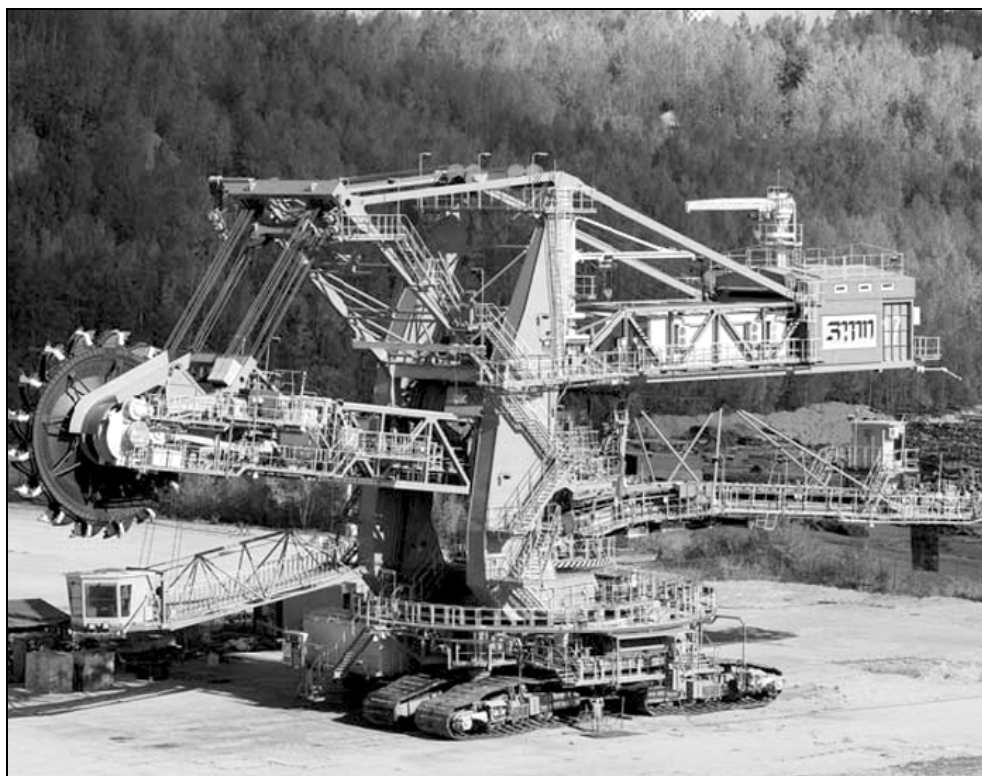
Rys. 1. Koparka kołowa wielonaczyniowa KWK 910 zaprojektowana do eksploatacji w gruntach trudno urabialnym KWB „Turów” SA
