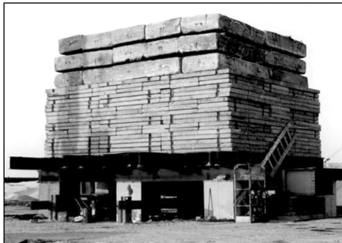
Rys. 1. Stanowisko do badań statycznych pali wielkośrednicowych
