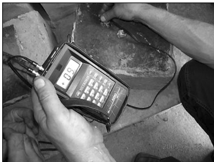
Rys. 8. Weryfikacja metody pomiaru grubości rury stalowej na specjalnie preparowanych próbach
