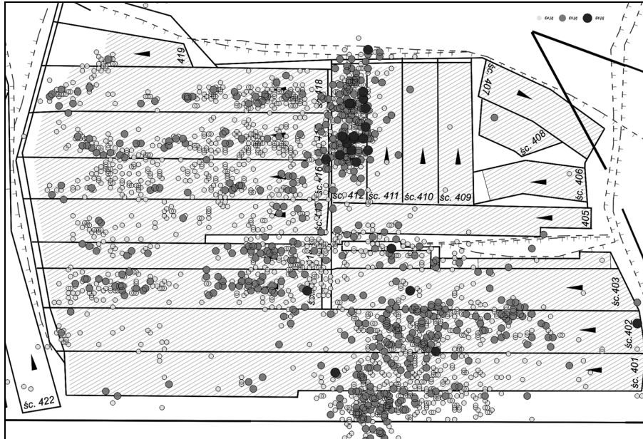
Rys. 1. Wstrząsy zarejestrowane przez Stację Geofizyki KWK „Ziemowit” w trakcie eksploatacji pokładu 207 w bloku F
