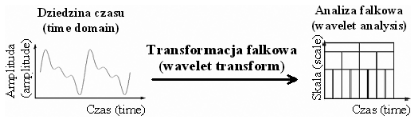
Fig. 1. Idea transformacji falkowej – przejście z domeny amplituda czas do domeny skala-czas
