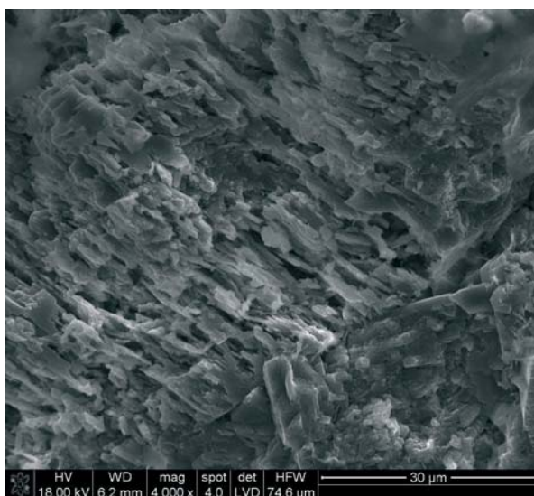
Fig. 3. Piaskowiec kredowy z Długopola po działaniu par kwasu siarkowego. Silnie rozpuszczone ziarno skalenia. Mikrofotografia SEM
