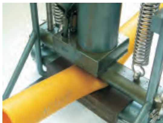
Rys. 7. Próbką rurową PE zaciskana pomiędzy wałcem a ceownikiem
