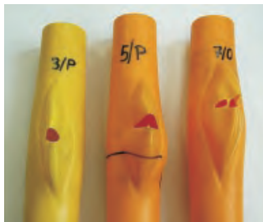
Rys. 8. Próbki rurowe PE po rozerwaniu w trakcie próby hydrostatycznej
