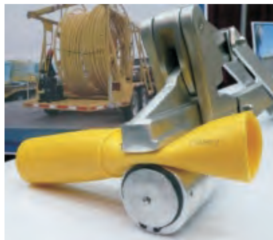
Rys. 4. Urządzenie do zaciskania rur PE o zróżnicowanym kształcie elementów zamykających, stosowane głównie do zaciskania rur z PA 11 [9]
