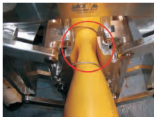
Rys. 5. Urządzenie do zaciskania rur PE z elementami zamykającymi o dużym promieniu krzywizny [4]
