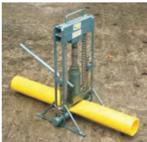
Rys. 1. Urządzenie do zaciskania rur PE (Laboratorium Tworzyw Sztucznych INiG)
