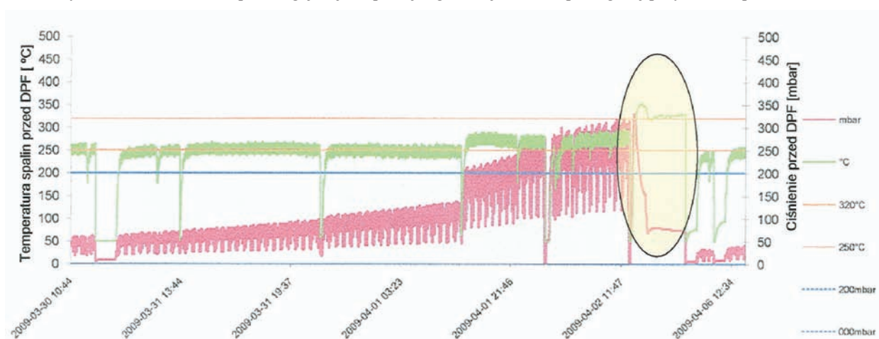
Rys. 7. Proces okresowo przebiegającej, niepełnej regeneracji DPF, wspomaganą pasywnie za pomocą FBC
