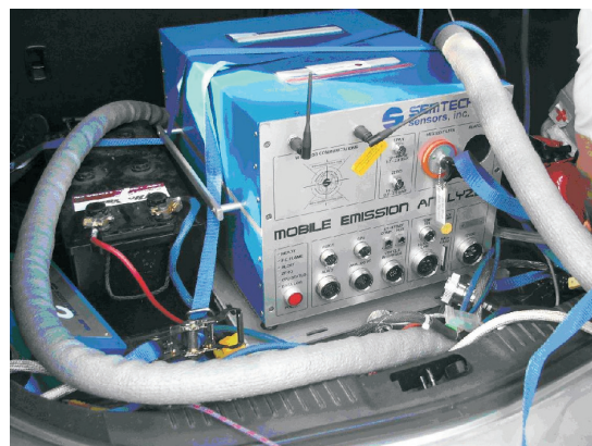
Rys. 2. Przewoźny zestaw analizatorów SEMTECH DS (fot. autor)
