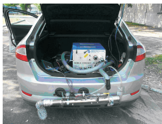
Rys. 3. Przewoźny zestawu analizatorów SEMTECH DS wraz z przepływomierzem EFM firmy Sensors, zamontowany w samochodzie badawczym (fot. autor)
