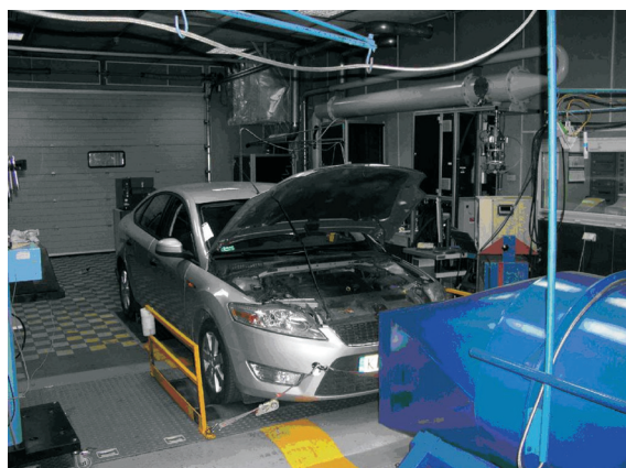
Rys. 8. Samochód osobowy podczas badań stanowiskowych – hamownia podwoziowa AVL-Zoellner (fot. autor)
